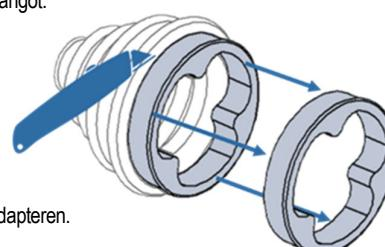
**Összeszerelési javaslat:** Ne használjon WD-40 permetet vagy hasonló anyagot a féltengely-gömbcsukló tisztításához, mert ami a száradást követően visszamarad belőle, az kedvezőtlenül befolyásolja az új féltengelyzsír hatékonyságát.
