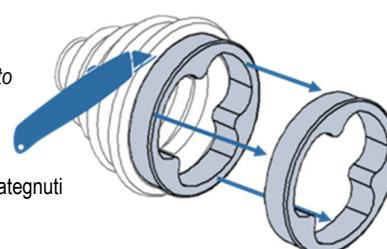
**Savet za postavljanje:** Nemojte koristiti WD-40 ili sličan proizvod za čišćenje homokinetičkog zgloba zato što će se nakon sušenja pojavit ostaci koji mogu negativno da utiču na novu mast za zglob.
