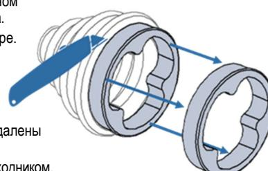
**Совет по монтажу:** Не используйте WD-40 или подобный продукт для очистки шарнира ШРУС, при высыхании он будет оставлять осадок, который отрицательно повлияет на новую смазку ШРУСа.
